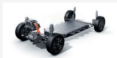
Umístění trakční baterie v podlaze vozu
